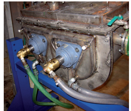
Obr. 4 – Pohled do vnitřní části dvojitého šnekového chladiče
