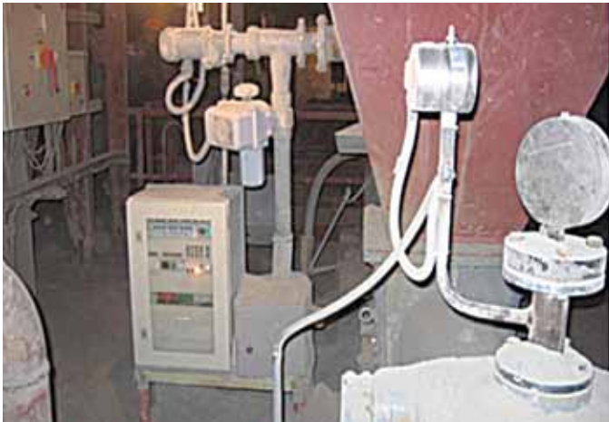
Рис. 10. Узел автоматизированного отбора образцов цемента после мельницы с помощью шнека (Buzzi Unicem/Dyckerhoff, завод «ЮГцемент», Украина)
